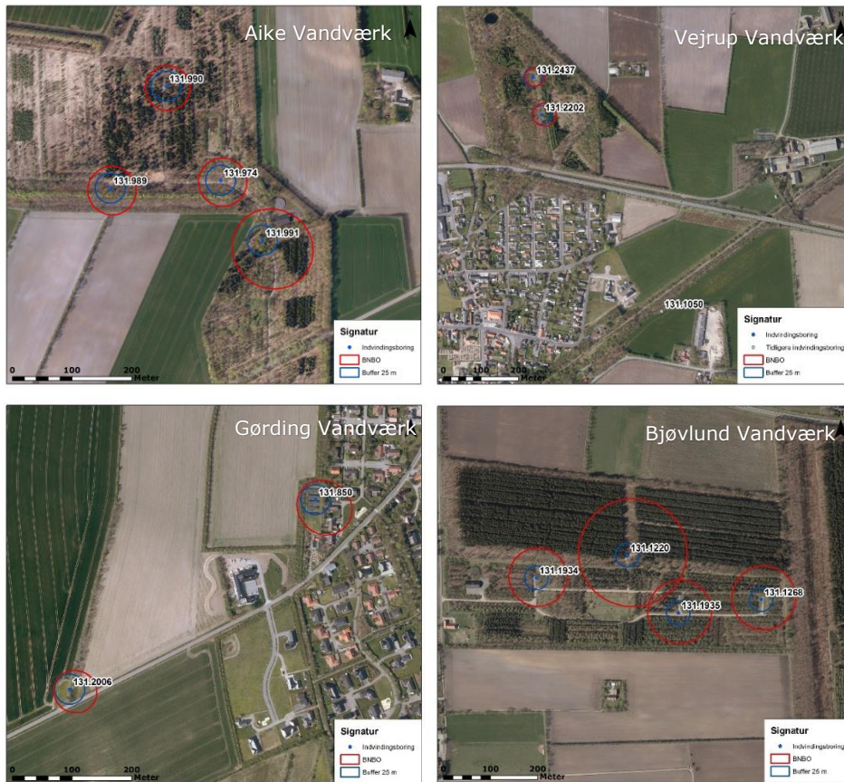
Figur 1. Boringsnære beskyttelsesområder (BNBO) og 25 m beskyttelseszoner for de aktive indvindingsboringer til Aike, Vejrup, Gørding og Bjøvlund vandværker.
